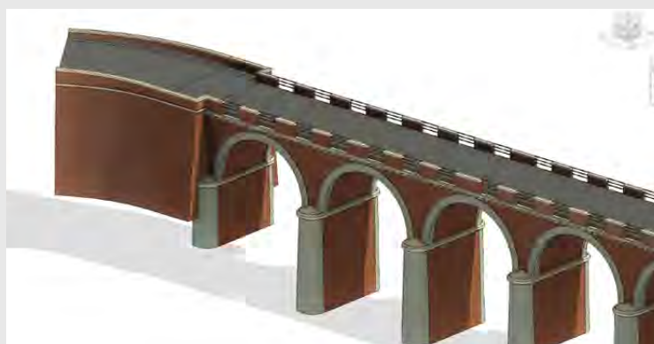
Scansione laser e restituzione BIM del ponte storico in Val d'Orcia
